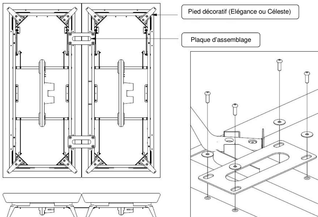
**Etape 6a: Montage de la ferrure de la tête de lit – Retrait des plaques de recouvrement**
