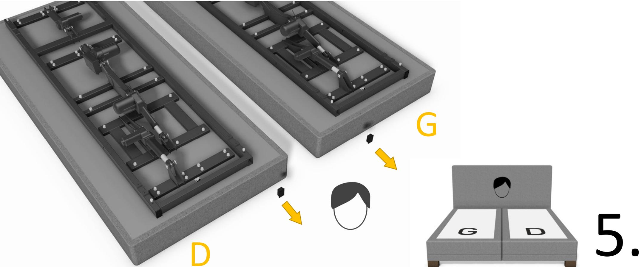
Étape 5. Retrait des embouts des tuyaux de châssis en préparation de l'installation de la ferrure de montage.
